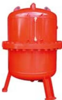
FT型原液タンクはFP型混合器とのコンビネーションにより、プレッシャープロポーション方式として設置される原液貯蔵タンクです。タンク内部は良質のダイヤフラムを採用し、貯蔵泡原液と供給水を完全分離し、供給水による原液の変質を完全に防止しています。
